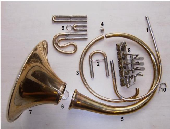
**Abb. 3:** Einzelteile des Waldhorns: 1 – Mundrohr; 2 – Stimmbojen; 3 – Anstoß; 4 – Zwingen; 5 – Stengel; 6 – Verschraubung; 7 – Schallbecher; 8 – Maschine; 9 – Ventilbögen; 10 – Fingerhaken (Foto: B. Meyer).
