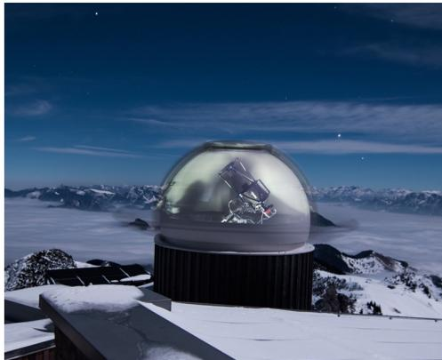
43cm Teleskop (Dall Kirkham) mit optischer CMOS-Kamera und einfachem Feldspektrograph vom Hörsaal in München aus steuerbar.
