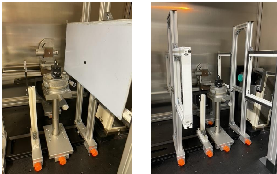
Abbildung 8. (Links) Inneres der Laue-Apparatur mit eingebautem Goniometer für Reflexions- und Transmissionsmessung. Die Bildplatte ist hier für eine Reflexionsmessung montiert. (Rechts) Goniometer mit Kollimator (grünes Gehäuse).
