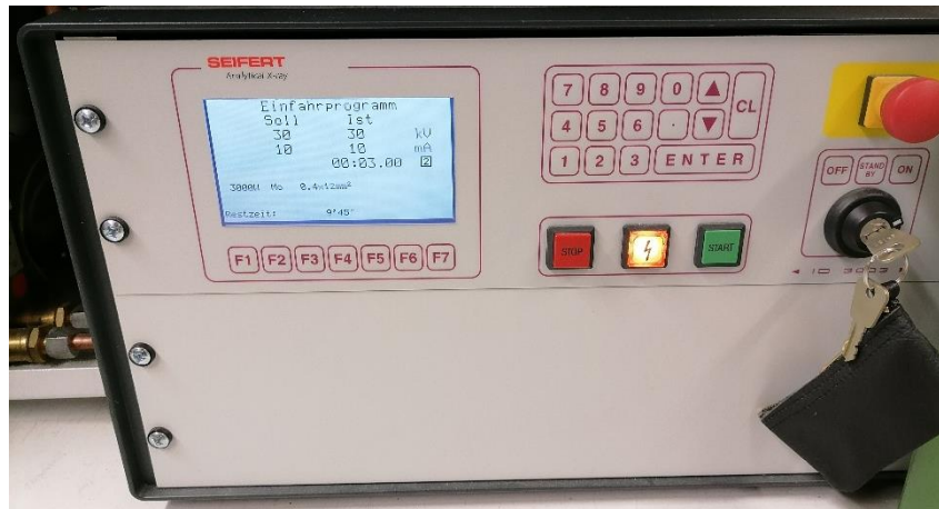
Abbildung 11. Hochspannungsgenerator zum Einstellen von Spannung, Stromstärke und Belichtungsdauer. Gezeigt ist das Einfahrprogramm beim Einschalten der Röntgenquelle.
