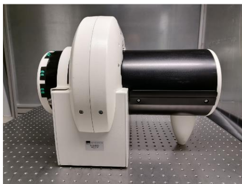
Abbildung 12. Image-Plate Scanner zum Einlesen der Bildplatte und anschließender Übertragung der Laue-Aufnahme auf den PC.
